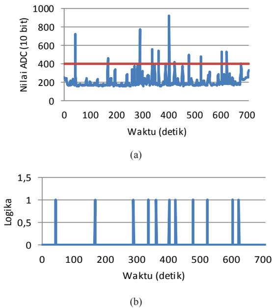
Gambar 3. Output sensor EMG pada tangan kanan, (a) dengan threshold 2 volt, (b) logika hasil threshold
